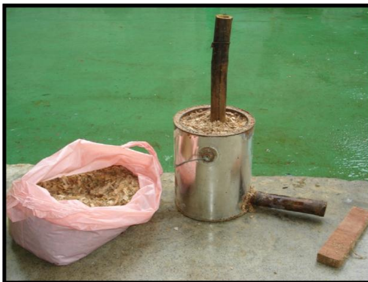
Imagen 1. Cocina de aserrín y sus materiales
